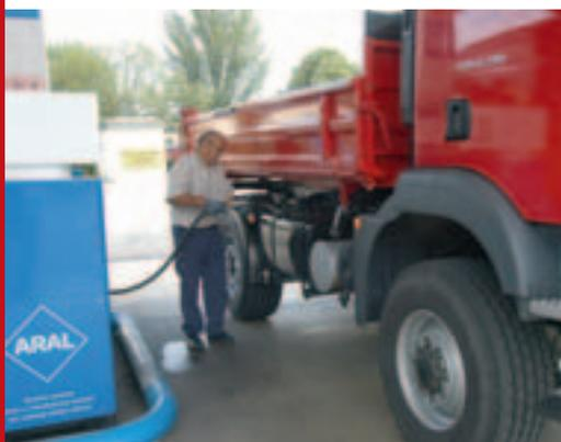
Getankt wird nur Diesel. Der MAN erfüllt Euro 4 mit Abgasrückführung und PM-Kat.
