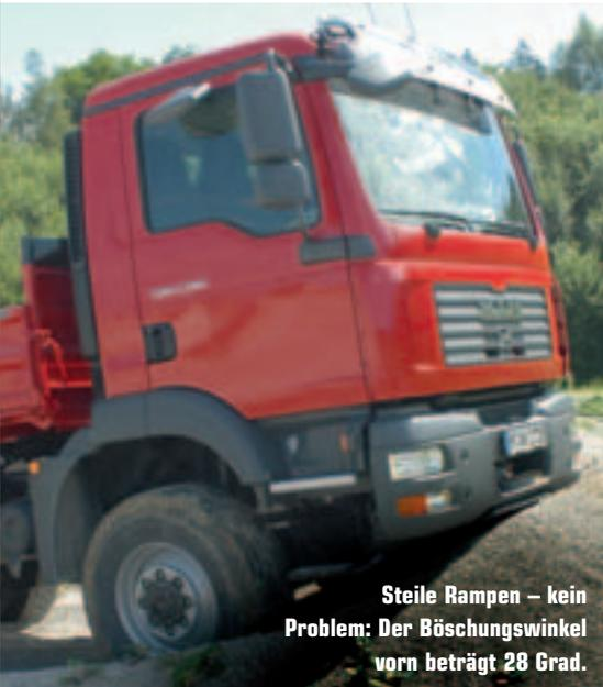
Steile Rampen – kein Problem: Der Böschungswinkel vorn beträgt 28 Grad.
