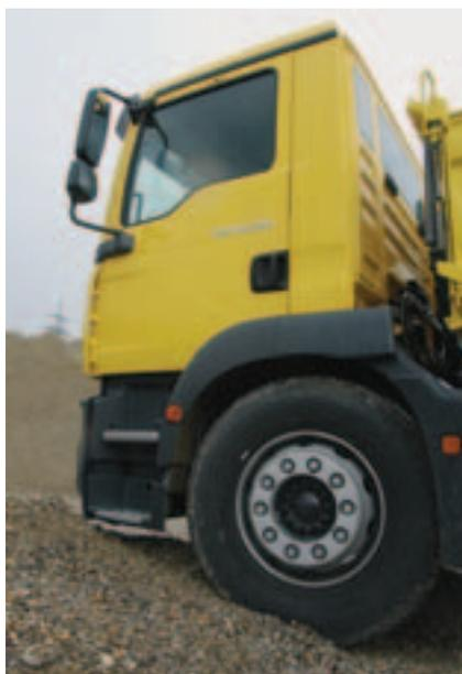
Hoher Einstieg über zwei Stufen mit ausreichendem Böschungswinkel vorn – die Stoßfänger und Einstiegskästen aus Kunststoff sind allerdings latent gefährdet.
