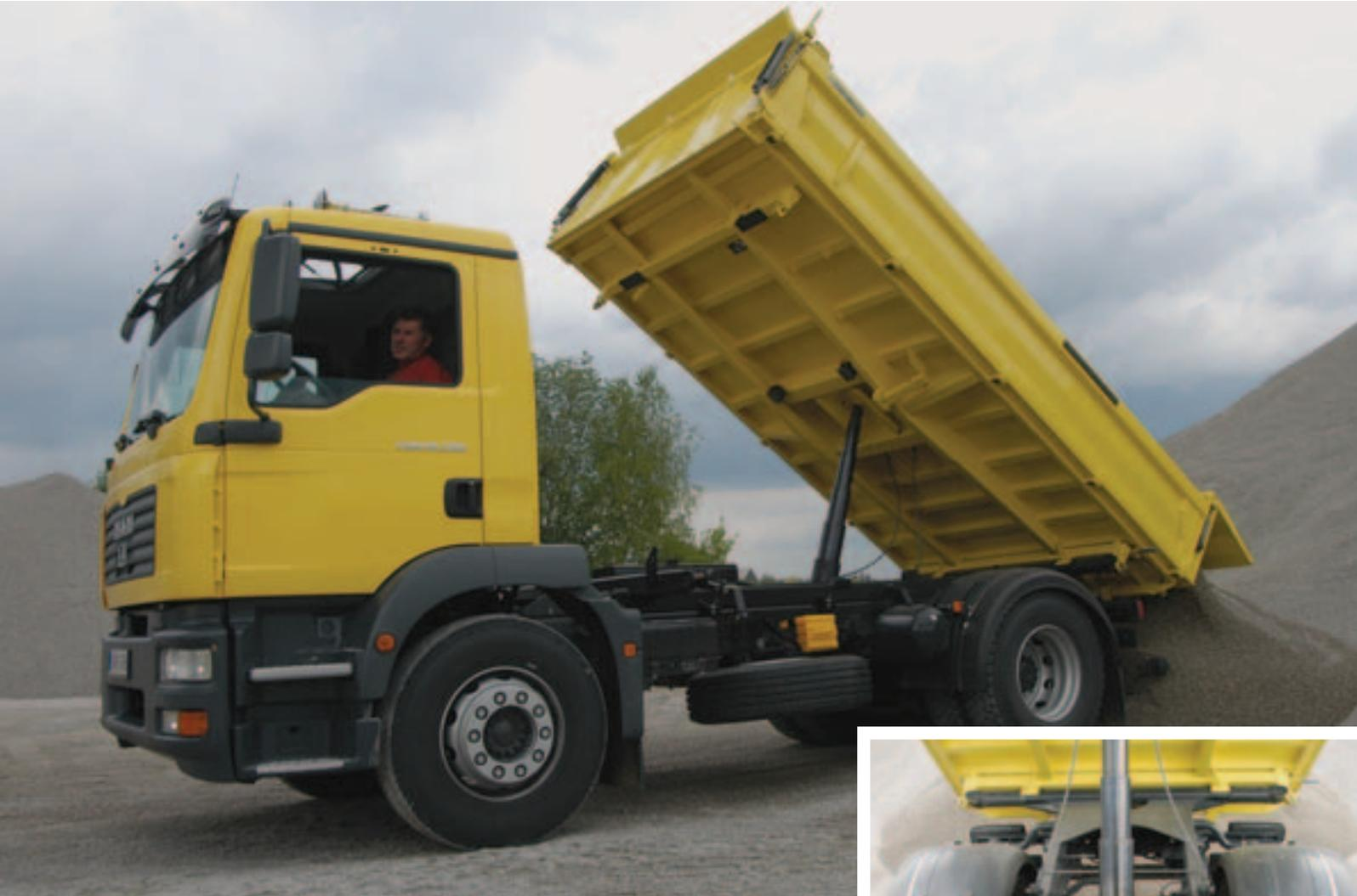
**1.650 kg wiegt der Meiller-Aufbau, die Öffnung der Bordwand wird durch Federkraft unterstützt.**
