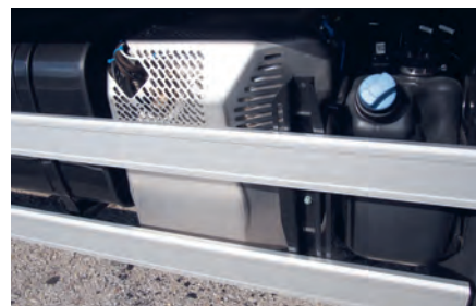
Nah am Motor: SCR-Abgassystem und Adblue-Behälter.
