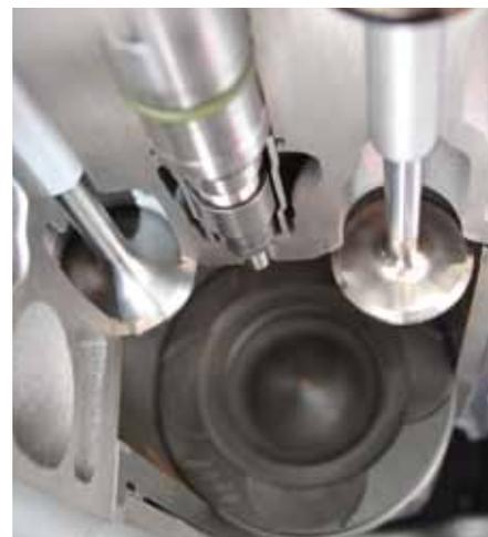
**Motoren-Highlights: 2.500 bar Einspritzdruck, Wölbventile, Lauffbuchse mit oberem Feuerring und geschmiedeter Stahlkolben**
