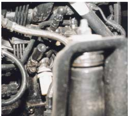
Handpumpe hinter der Luftleitung
