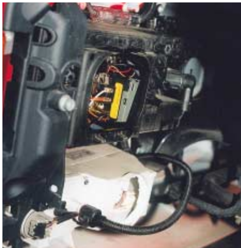
Nur mit gekippter Kabine erreichbar: die Frontscheinwerfer
