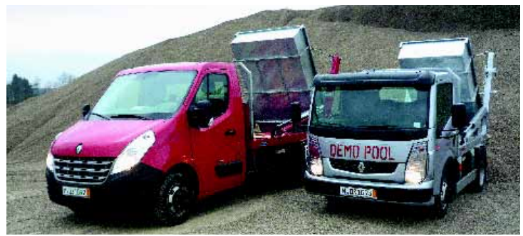
Master und Maxity, zwei kleine Absetzkipper für kleine Bauvorhaben
