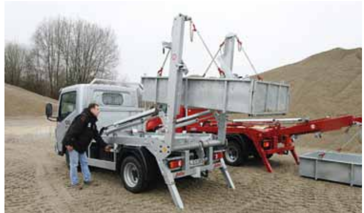
Einfach und professionell zu bedienen – für die Hydraulik gibt's den Nebenabtrieb.
