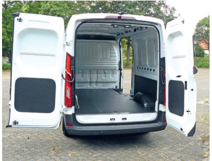
Die Ladekante des eDeliver9 liegt hoch, denn drunter ruhen große Batteriesätze. Ausgangsmodell ist ein Diesel mit Hinterradantrieb.
