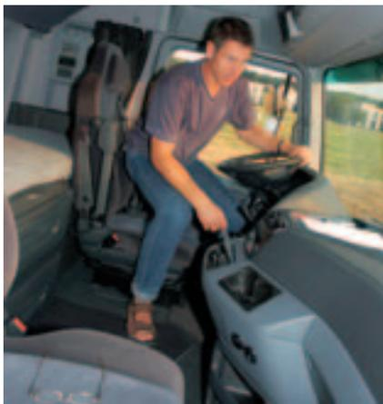
**Der ebene Fahrerhausboden mit einer durchgehenden Stehhöhe von 1,92 m im Megaspac ist das Kennzeichen des wahren Komforts.**
