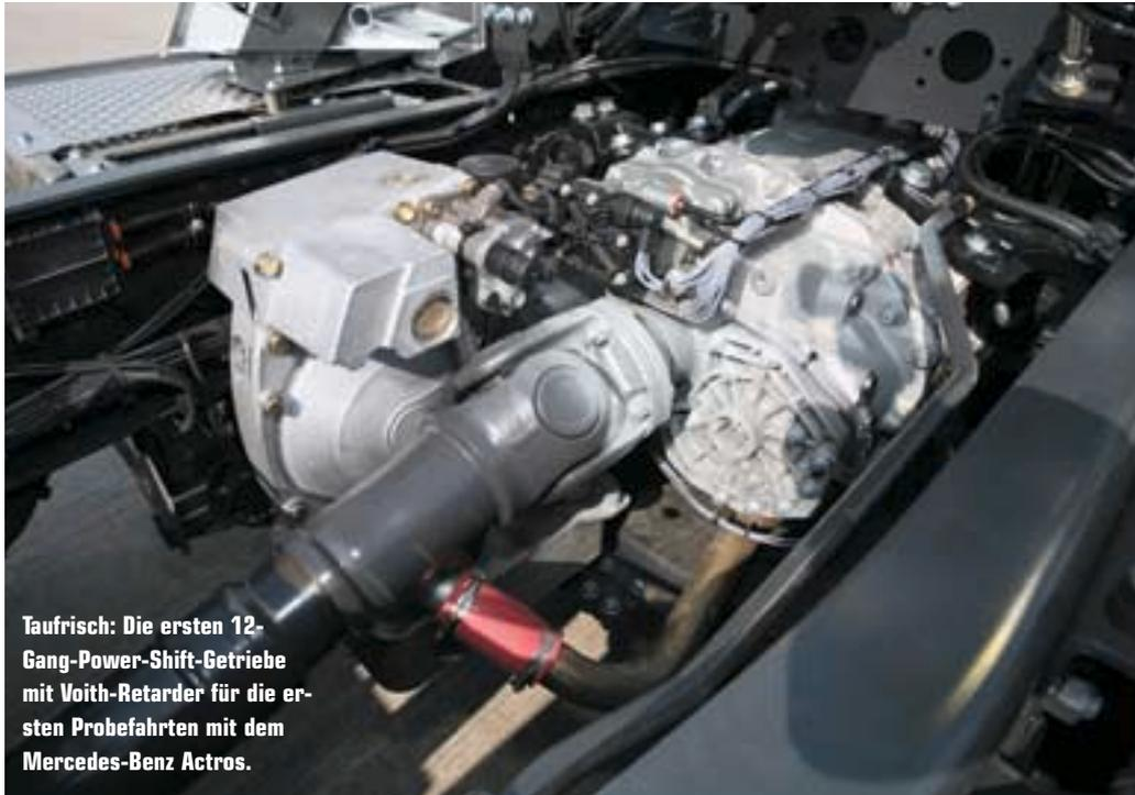
**Taufrisch: Die ersten 12-Gang-Power-Shift-Getriebe mit Voith-Retarder für die ersten Probefahrten mit dem Mercedes-Benz Actros.**
