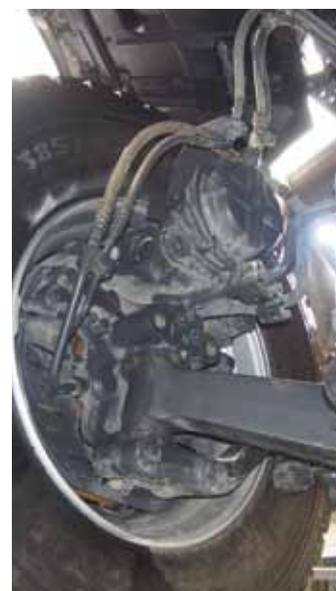
Die Radnabenmotoren werden direkt durch Achsbolzen und Achszapfen mit Hydrauliköl versorgt.
