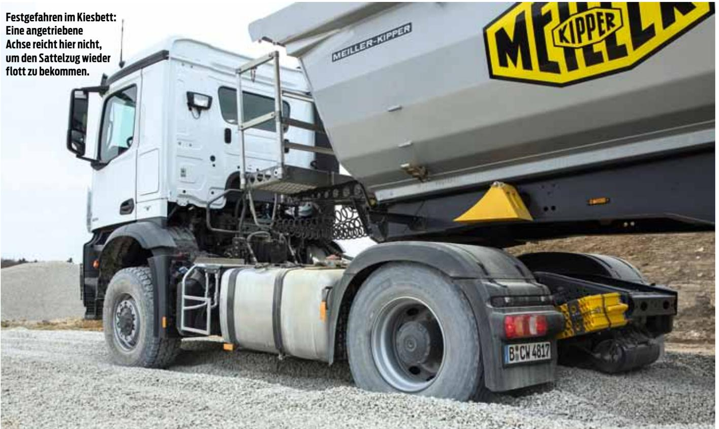
Die Spitzkehre in der Steigung: Die Differenzialsperre der Hinterachse kann hier nicht helfen, hier löst der neue HAD-Antrieb das Traktionsproblem der Vorderachse.
