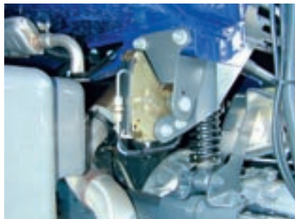
Die Komfortlagerung „1,8 Hz“ bringt mehr Bequemlichkeit für den Fahrer.
