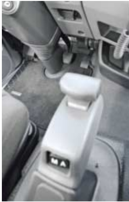
Die Telligent-Schaltautomatik entmündigt nicht den Fahrer, er kann über den Wahlhebel auch im Automatikmodus jederzeit eingreifen.
