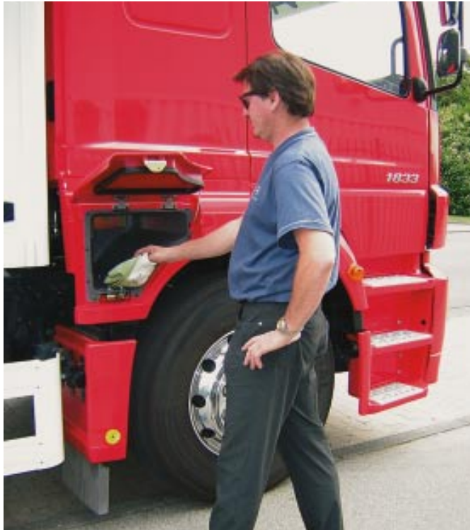
Das Außenstaufach für Warmausrüstung, Werkzeug und Tankutensilien ist bei den Fahrern beliebt.
