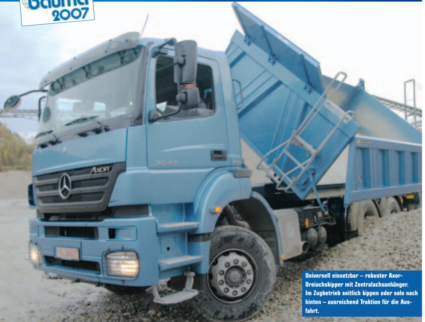
Universell einsetzbar – robuster Axor-Dreiachskipper mit Zentralachsanhänger. Im Zugbetrieb seitlich kippen oder solo nach hinten – ausreichend Traktion für die Ausfahrt.
