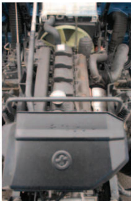
**Der Musterknabe unter der Kabine – Reihensechszylinder OM 457 LA mit 428 PS und 2.100 Nm.**
