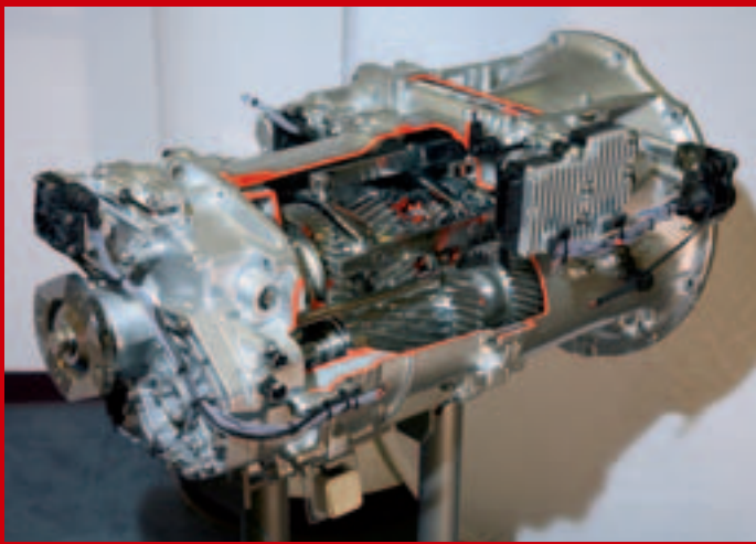
Die Bauart als Klauenschaltgetriebe mit unsynchronisiertem 3-Gang-Grundgetriebe spart Baulänge und Gewicht.
