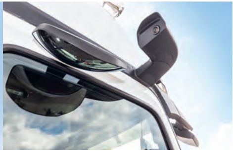
Eines der zahlreichen Highlights: die Mirror-Cam beim neuen Actros
