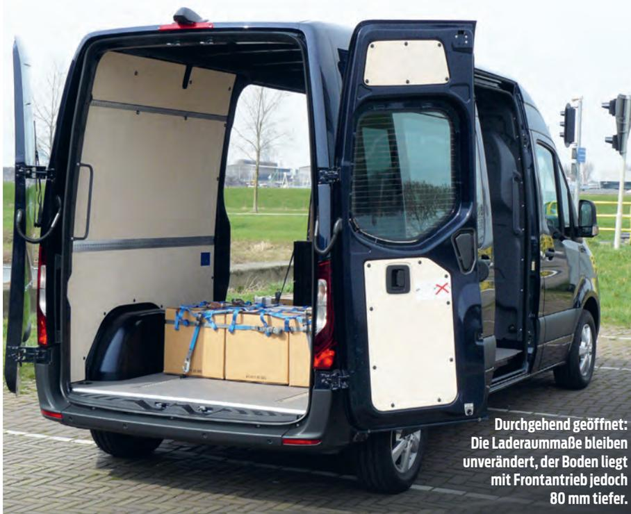
Durchgehend geöffnet: Die Laderaummaße bleiben unverändert, der Boden liegt mit Frontantrieb jedoch 80 mm tiefer.
