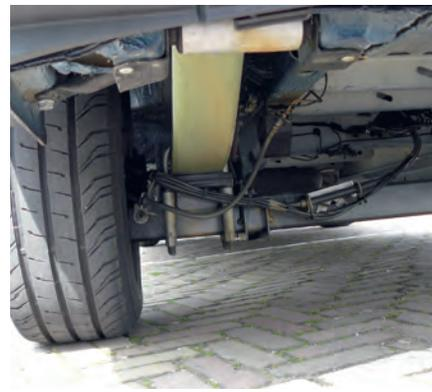
**Tiefer Blick: Der Fronttriebler bekommt eine einfache Hinterachse aus einem Stahlprofil, optionale GfK-Federn sparen Gewicht.**
