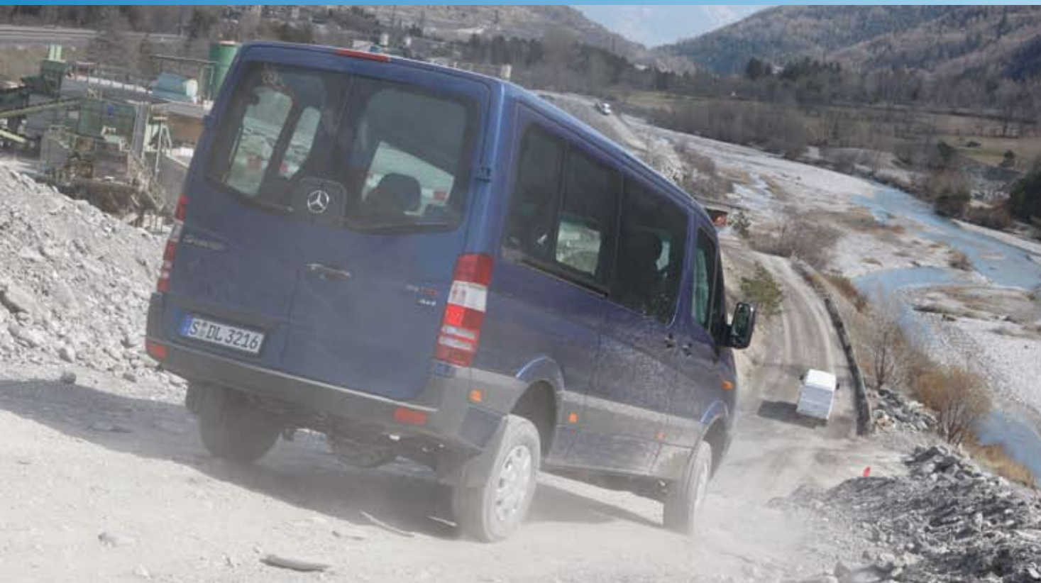
Der Sprinter 4x4 liegt 110 Millimeter höher als sein zweiradgetriebener Bruder. Die Antriebstechnik entspricht der des Vito, jedoch ist der Allradantrieb zuschaltbar und es gibt optional eine Untersetzung.
