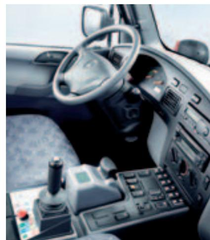
Eng geschnittenes Stahlfahrerhaus mit verstellbarer Lenksäule, rechts die Bedienkonsole mit Telligent-Schaltknopf, dahinter der Joystick für den Gerätebetrieb
