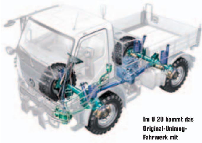
**Im U 20 kommt das Original-Unimog-Fahrwerk mit schraubengefederten Portalachsen zum Einsatz – mittig das sperrbare Verteilergetriebe. Vor der Vorderachse sitzt das Zapfwellenge triebe mit Abtrieb für Anbaugeräte.**
