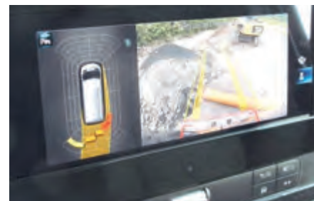
Rundum schützen auf Wunsch Sensoren die Karosserie. Sie warnen rechtzeitig bei der Annäherung an Hindernisse.
