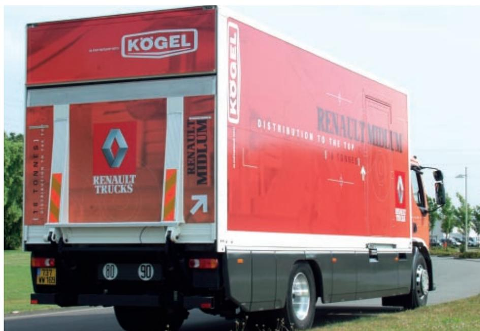
Mit Trockenfracht-Kofferaufbau und Ladebordwand lässt sich beim Midlum ein Leergewicht von 7.442 kg realisieren.
