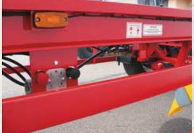
**Armaturen: Park-Löse-Sicherheitsventil und Verriegelungs-Schaltventil**
