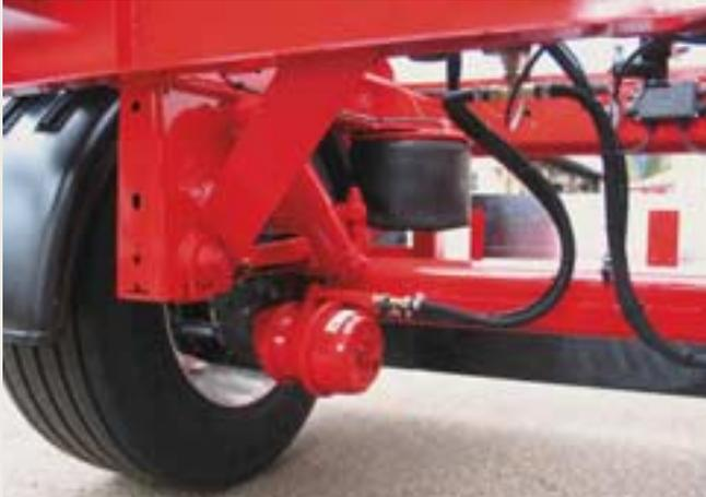
**BPW-Airlight: Bremszylinderanschlüsse oben**
