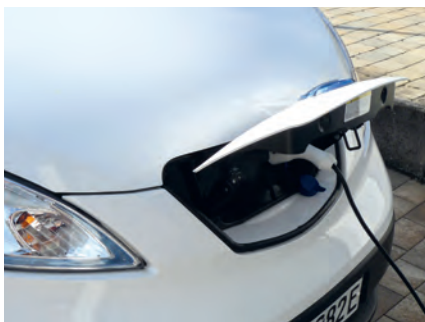
Zwei Stecker unter der Frontklappe, für Haussteckdose und Wallbox sowie Chademo-Schnellladung
