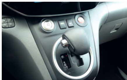
Schaltzentrale: Taste für Start und Fahrmodus, Wählhebel für die Fahrtrichtung und die Wahl für den Bremsmodus.
