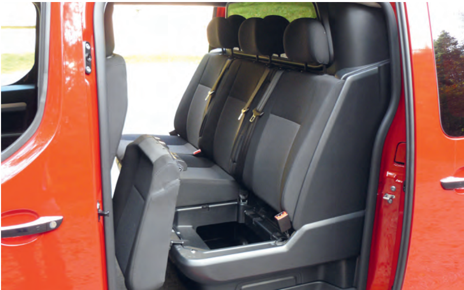
Die Doppelkabine bietet hinten drei Einzelsitze, links und in der Mitte mit praktischer Sitztruhe, rechts Unterlademöglichkeit.
