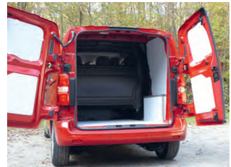
Opel verkleidet den Laderaum auf Wunsch, einschließlich professionell überbauter Radkästen.
