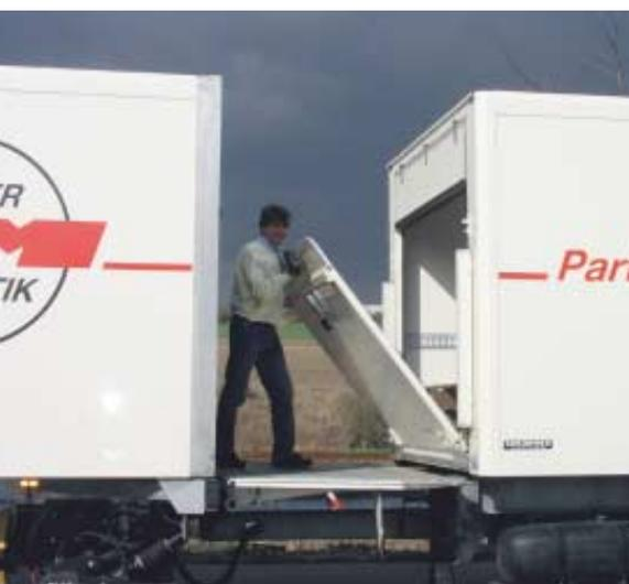
Die Durchladeeinrichtung ermöglicht die schnelle Komplettbeladung im Depot und das Nachladen im Soloeinsatz unterwegs.
