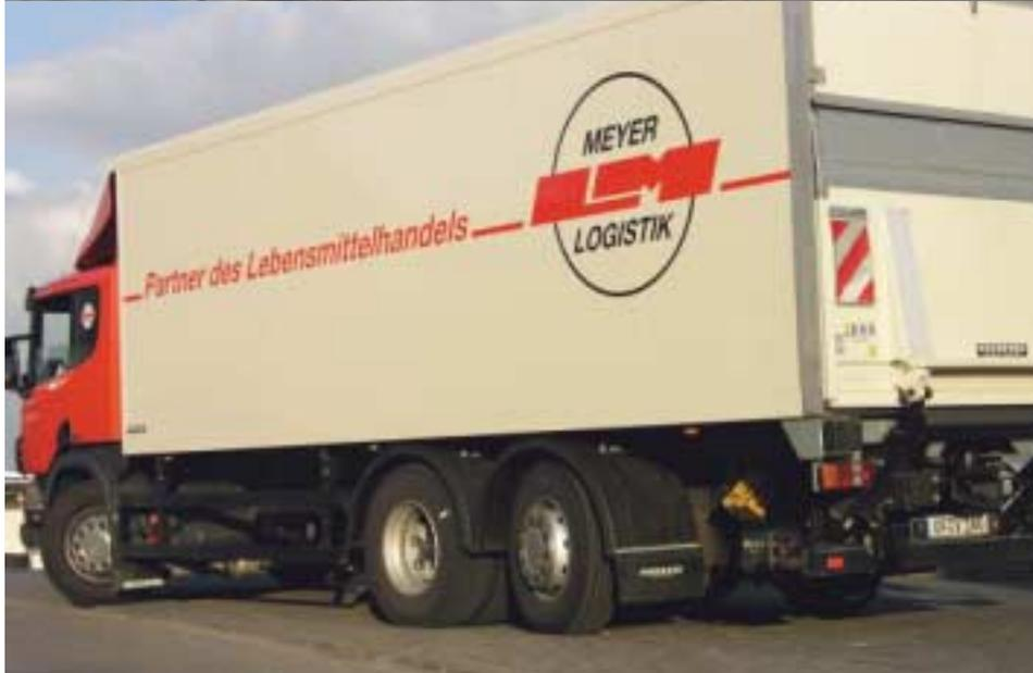
Die hydraulisch zwangsgelenkte Nachlauf-Liftachse macht den P 114/380 zum wendigen Solo-Verteilerfahrzeug.
