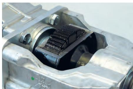
**Aufgeschnitten: Die ölgefüllte Visko-Kupplung mit Lamellen überträgt bei Drehzahldifferenzen Kraft auf die Hinterräder.**
