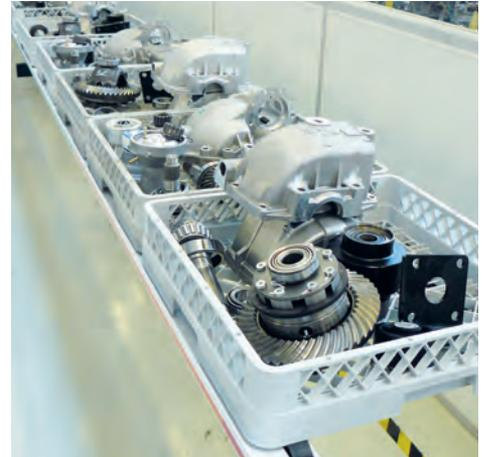
Aufgeräumte Fertigung, die Allradkomponenten liegen für jedes Fahrzeug auf einem Ladungsträger bereit.
