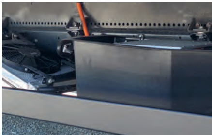
Kühler und Wechselrichter sowie die Steckdose sind in Fahrrichtung links zwischen den Achsen angesiedelt.
