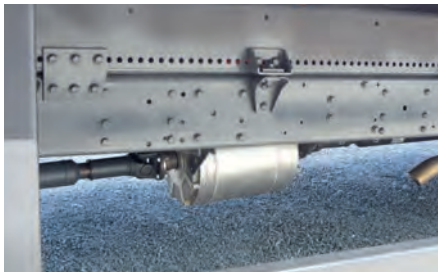
Der E-Motor ist kurz vor der Hinterachse angesiedelt, dort hat Quantron Kegel- und Tellerrad des Differenzials getauscht.
