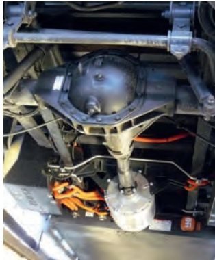
Blick unter den Bauch des Quantron: von vorne nach hinten reihen sich Batteriepaket, Elektromotor und Differential auf.
