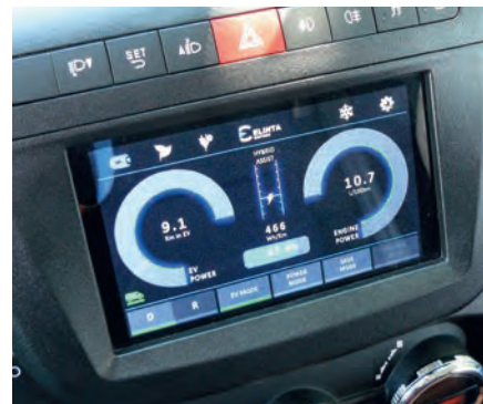
Berührungsempfindlicher Bildschirm als Informations- und Schaltzentrale im Cockpit des Quantron.
