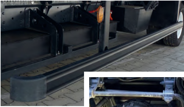
Großer Batteriekasten unter dem Rahmen des Trägerfahrzeugs. Die Position des Steckers lässt sich auf Wunsch versetzen.
