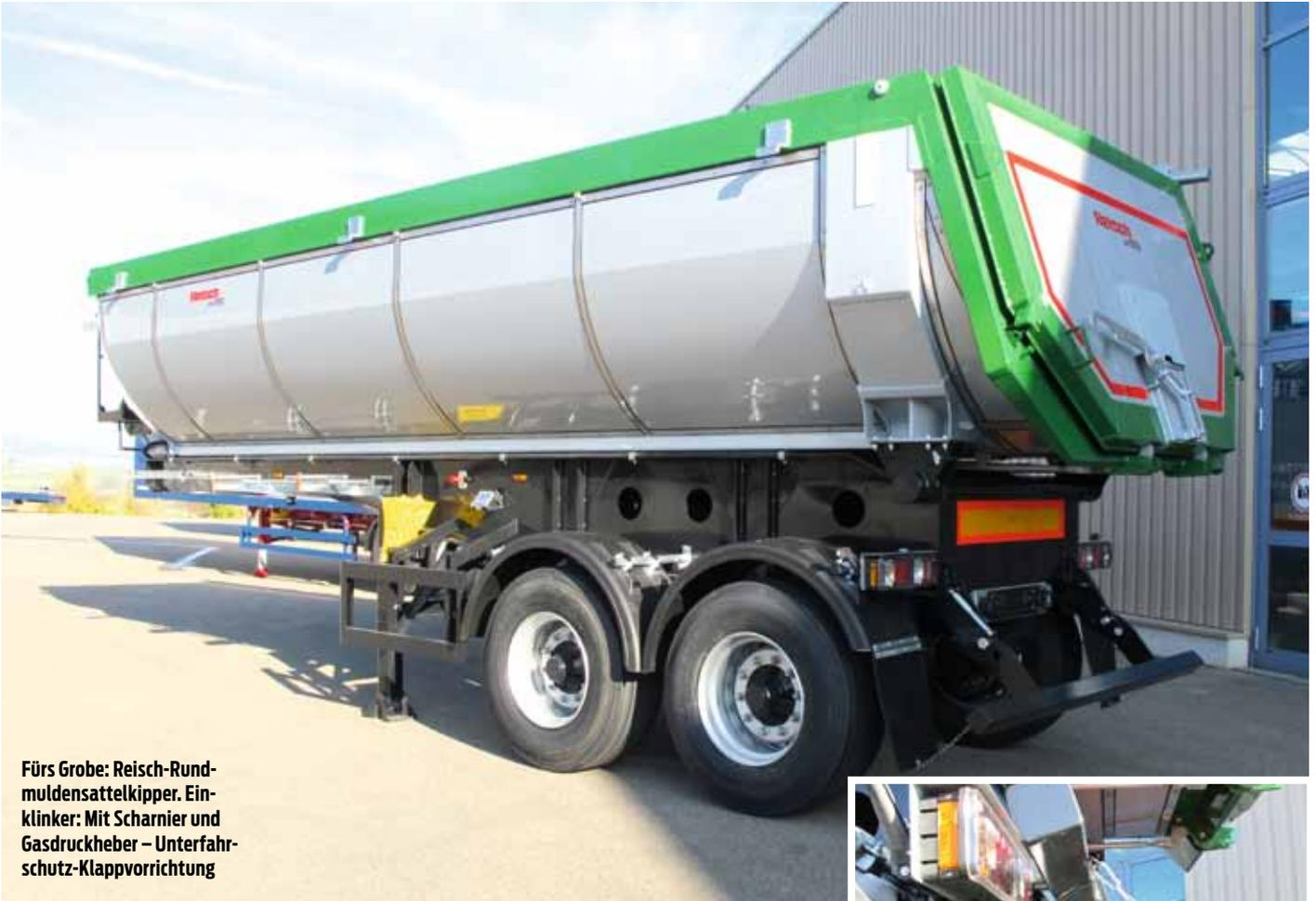
Fürs Grobe: Reisch-Rundmuldensattelkipper. Einklinker: Mit Scharnier und Gasdruckheber – Unterfahrerschutz-Klappvorrichtung
