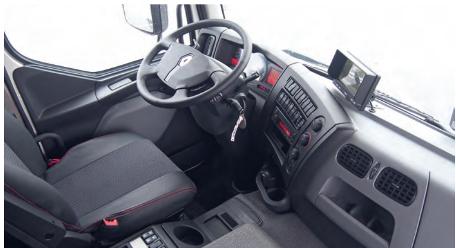
Ordentliche Platzverhältnisse im Fahrerhaus: Umstieg nach rechts ist möglich, das Lenkrad fällt groß aus, die französische Ergonomie verlangt Eingewöhnung.
