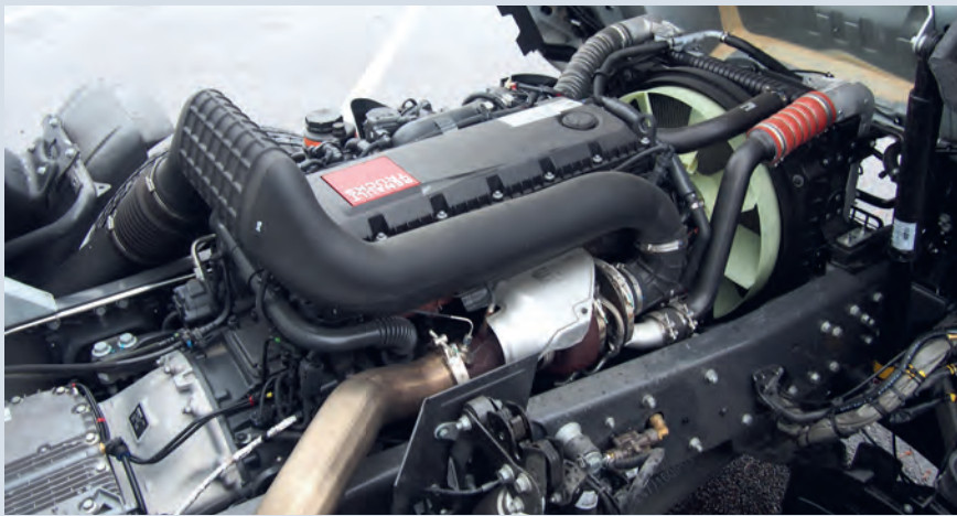
Noch relativ jung: DTI 8-Reihensechszylinder mit VTG-Turbolader, im Renault D Wide für maximal 320 PS gut
