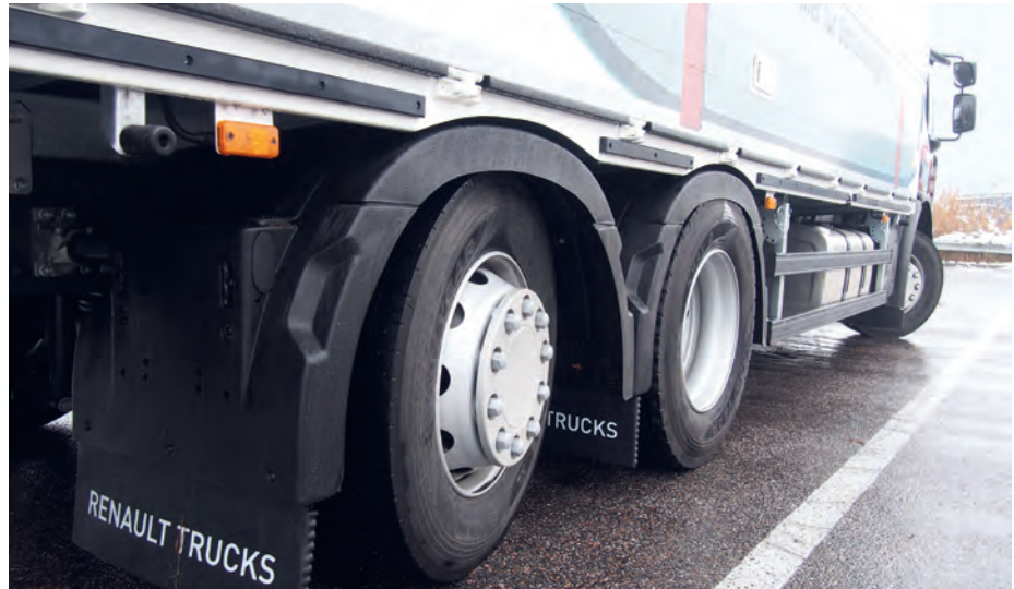
Trotz langem Radstand ziemlich wendig: Die Nachlaufachse lenkt hydraulisch mit.
