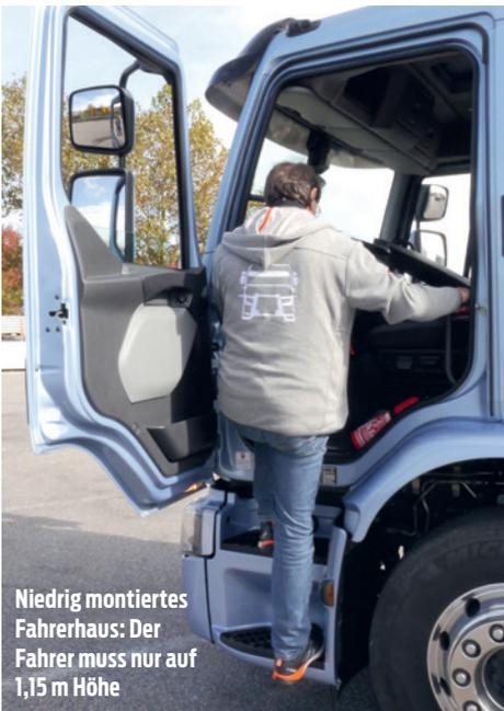
Niedrig montiertes Fahrerhaus: Der Fahrer muss nur auf 1,15 m Höhe
