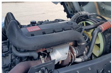
Kräftiges Triebwerk: Der 7,7 l große Reihensechszylinder sorgt für souveräne Fahrleistungen
