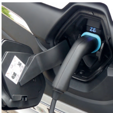
Das Ladekabel wird hinter vorne hinter dem Markenzeichen eingesteckt, hinter der Tankklappe ist ein Blinddeckel.
