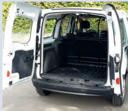
Der Laderaum des Kangoo Maxi als Fünfsitzer fasst gut einen Kubikmeter Fracht, das Trenngitter ist fest verschraubt.
