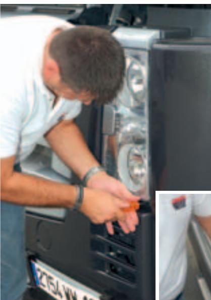
**Die Beleuchtungseinheit lässt sich für einen einfachen Birnenwechsel ausklappen.**
