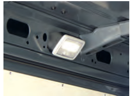
Auf Wunsch leuchten LED-Lampen stromsparend den Laderaum aus.
