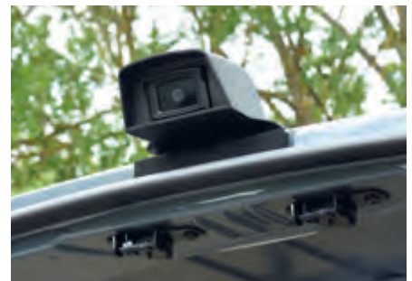
Die Kamera unterstützt wie gewohnt bei Rückwärtsfahrt. Sie vermittelt aber auch im Vorwärtsgang einen Blick auf den nachfolgenden Verkehr.
