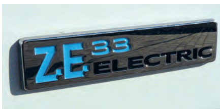
Unauffällige Kennzeichnung – die Zahl 33 steht nicht etwa für das zulässige Gesamtgewicht, sondern für die Kapazität der Batterie.
