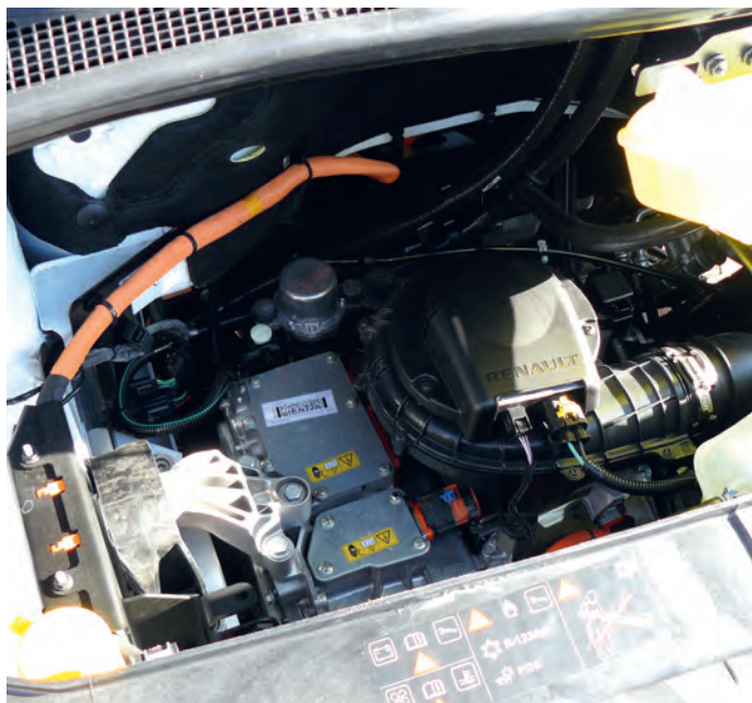
Der kompakte Elektromotor duckt sich tief unter der Haube, er arbeitet mit gleicher Leistung auch im Kangoo ZE.
