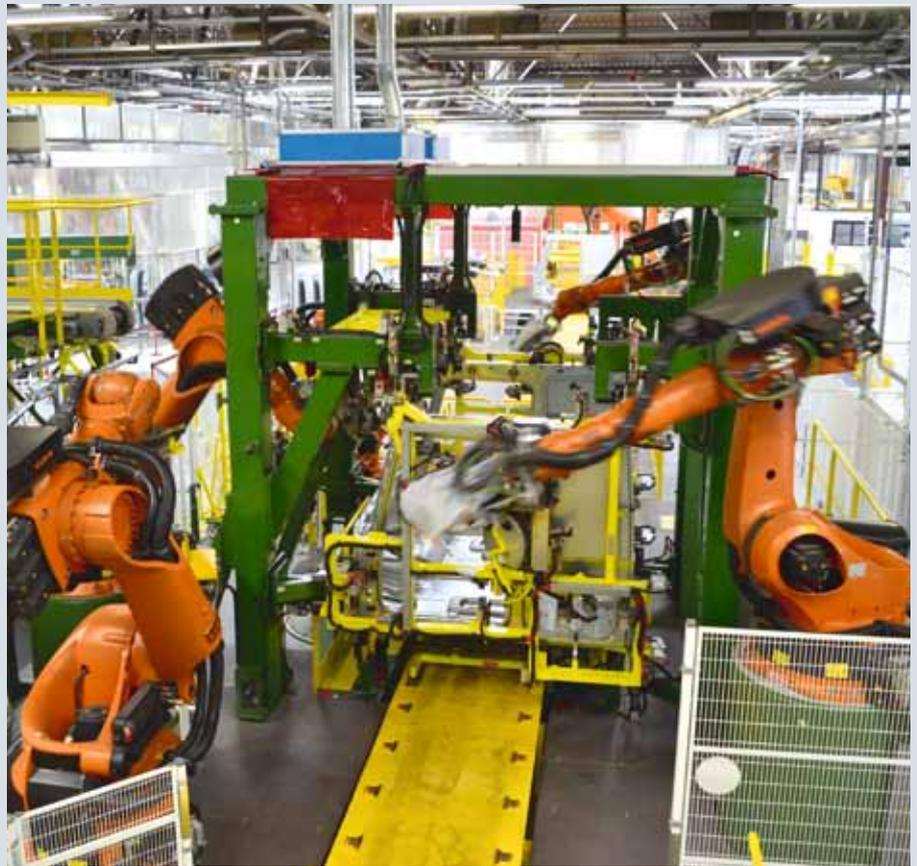
**Roboterbalett: automatisierte Kabinenfertigung mit höchster Qualität und Präzision**
