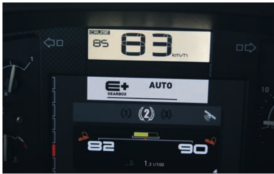
Alles im Blick: Anzeige des intelligenten Tempomaten Optivision
