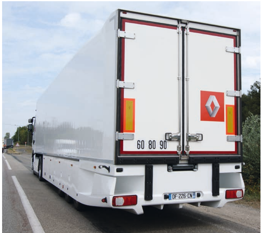
Trailer mit spezieller Heckverkleidung
