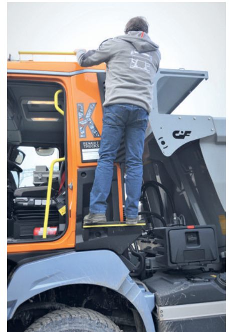
Sicherer Stand hinter der linken Tür: Breite Trittfläche mit Handlauf auf dem Dach für Einblicke in die Ladefläche.
