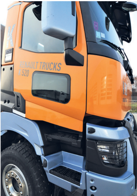
Überwachung des toten Winkels: Zusätzliches Türfenster rechts, zwei Überwachungskameras, Ultraschallsystem mit Warnfunktion.
