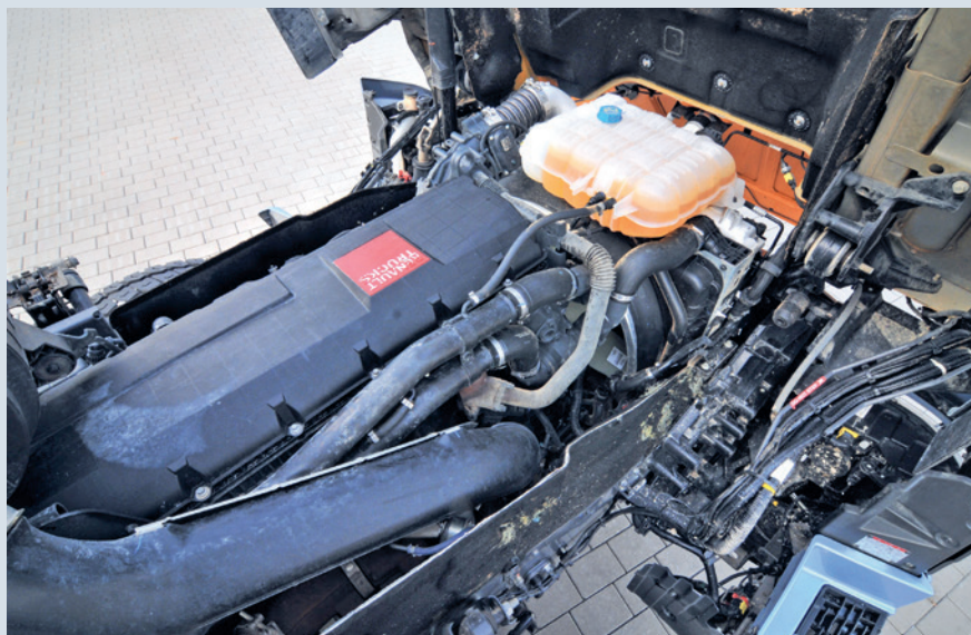
Kraftwerk unter der Kabine: Der 12,8 l große Reihensechszylinder aus dem Volvo-Konzernregal bietet viel Leistung und Drehmoment zu moderaten Kosten.
