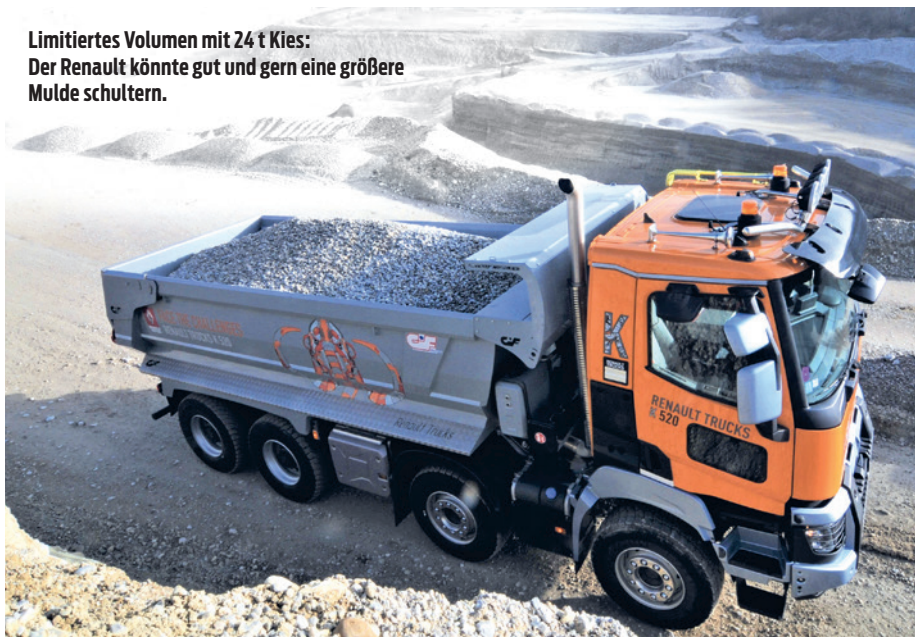
Hydraulische Heckklappe: Da passen auch grobe Felsbrocken und Abbruchmaterial durch.
