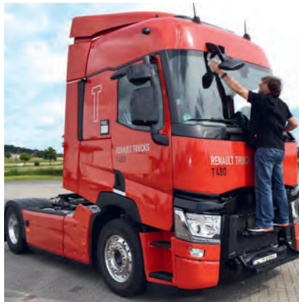
Bietet einen festen Stand, auch bei Eis und Schnee: die ausklappbare Trittstufe im Kühler (links); komfortabel und sicher: der Einstieg in die Fahrerkabine
