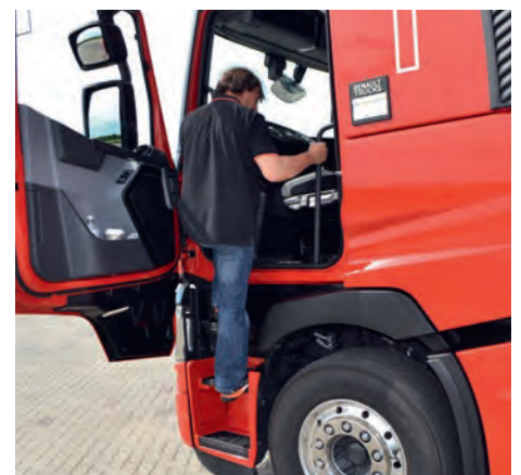
Bietet einen festen Stand, auch bei Eis und Schnee: die ausklappbare Trittstufe im Kühler (links); komfortabel und sicher: der Einstieg in die Fahrerkabine
