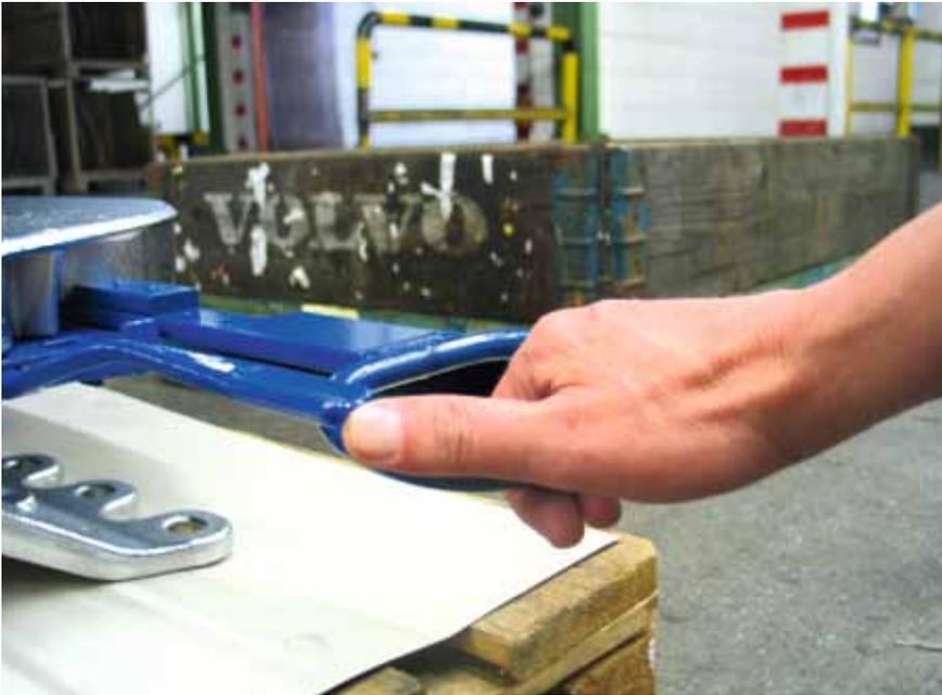
Pneumatische Lösevorrichtung. Bild rechts: Griff und Taste – Bedienungsprinzip bei SAF-Holland-GF-Kupplungen
