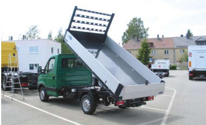
Kipper light neu: mit Elektrohydraulik
