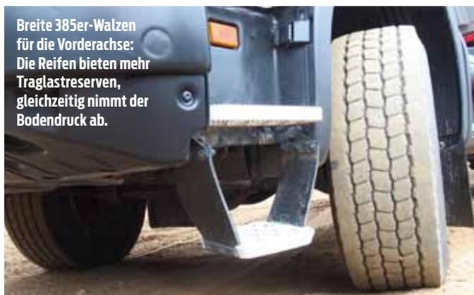
Breite 385er-Walzen für die Vorderachse: Die Reifen bieten mehr Traglastreserven, gleichzeitig nimmt der Bodendruck ab.
