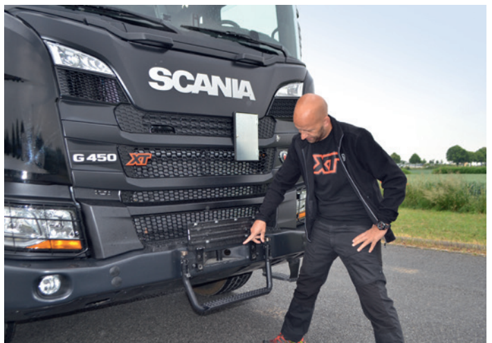
Unkompliziertes Handling, gewohnt intuitives Bedienkonzept: Blick ins Cockpit (oben links); komfortable Einstiegssituation (oben rechts); praktisch: das große Außenstaufach (unten links); außerdem sinnvoll: 40-t-Abschleppbolzen und Trittstufe vorne an der Fahrzeugfront
