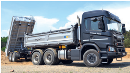
Flexible Schüttgutkombination: Dreiseitenkippaufbau plus Meiller-Zweiachs-Tandemkipper
