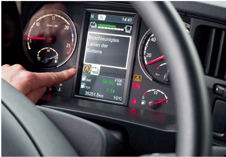
Voreingestellter Betrieb: Über zwei zusätzliche Kippschalter lassen sich zum Beispiel die Betriebsmodi „beschleunigtes Batterieladen“ und „Lautlosmodus“ aktivieren.
