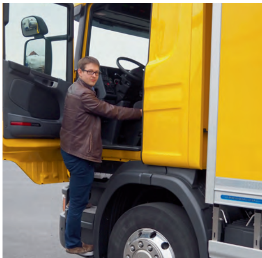
Sicherer Einstieg: rutschsichere treppenartig konzipierte Trittstufen, gut platzierte Haltegriffe und Sitzschnellabsenkung
