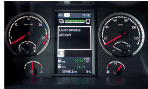
Voreingestellter Betrieb: Über zwei zusätzliche Kippschalter lassen sich zum Beispiel die Betriebsmodi „beschleunigtes Batterieladen“ und „Lautlosmodus“ aktivieren.
