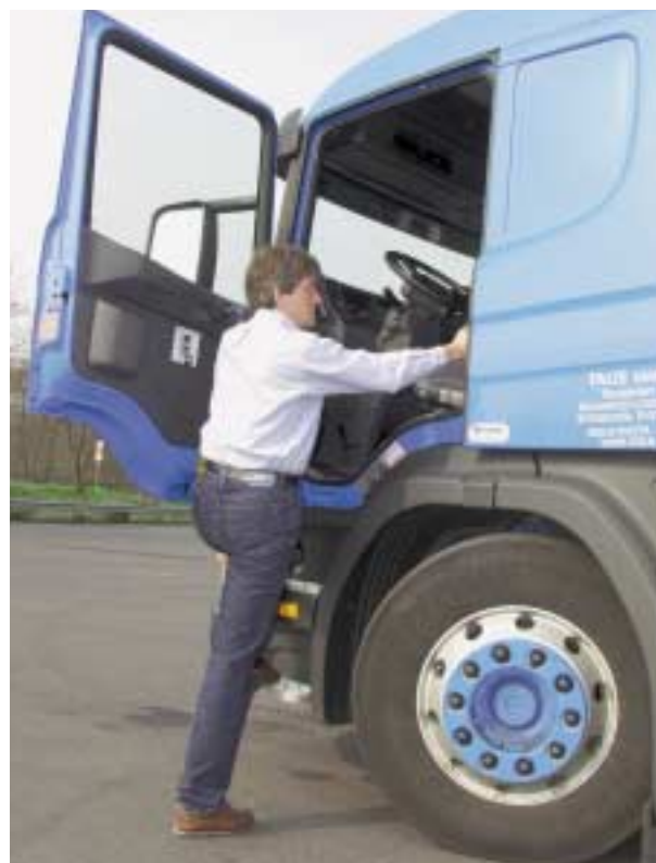
Artgerecht: Das CP-Fahrerhaus mit niedrigem Fußboden besitzt eine günstige Einstiegsituation für den Verteilerverkehr.
