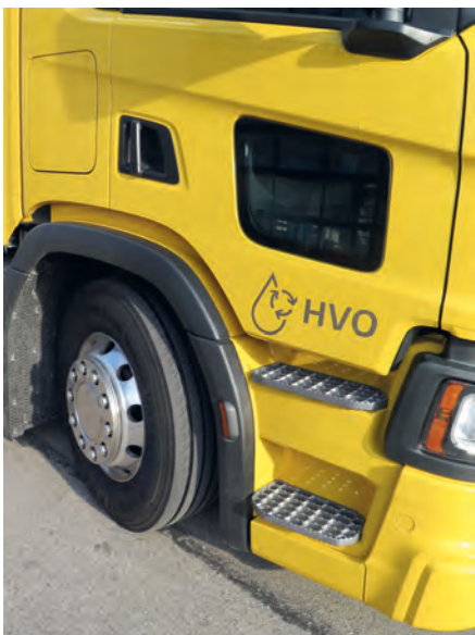
Speziell für den Verteiler-Verkehr konzipiert: niedrige Einstiegssituation, innovatives City-Fenster
