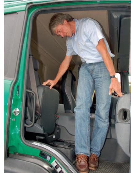
Der Beifahrer-Klappsitz ermöglicht eine Stehfläche.
