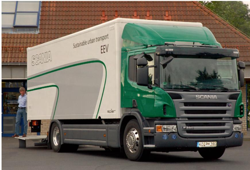
Das Testfahrzeug bringt leer mit vollem Tank, Aufbau und Ladebordwand etwa 9,2 t auf die Waage.
