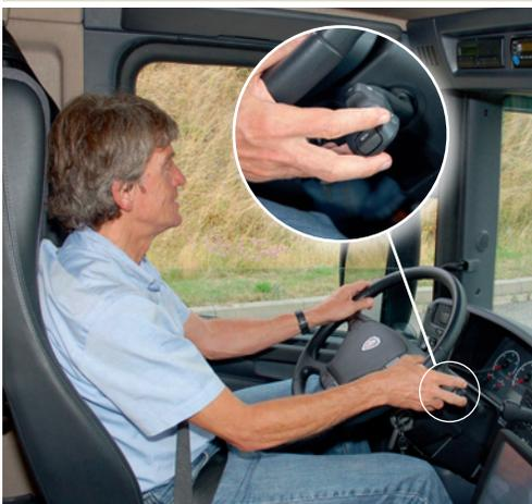
Einfaches Handling: Über diesen Tippschalter lassen sich zum Beispiel die manuelle Opticruise-Gangwahl und die Motorbremse aktivieren.
