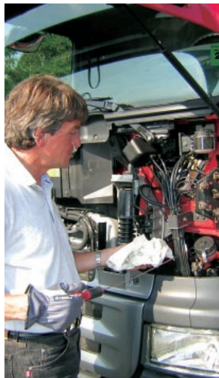
Auf Sicherheit: Die Kontroll- und Nachfüllpunkte sind gut erreichbar. Bei Scania gehört das Ölstandmessen noch zur Routinekontrolle.
