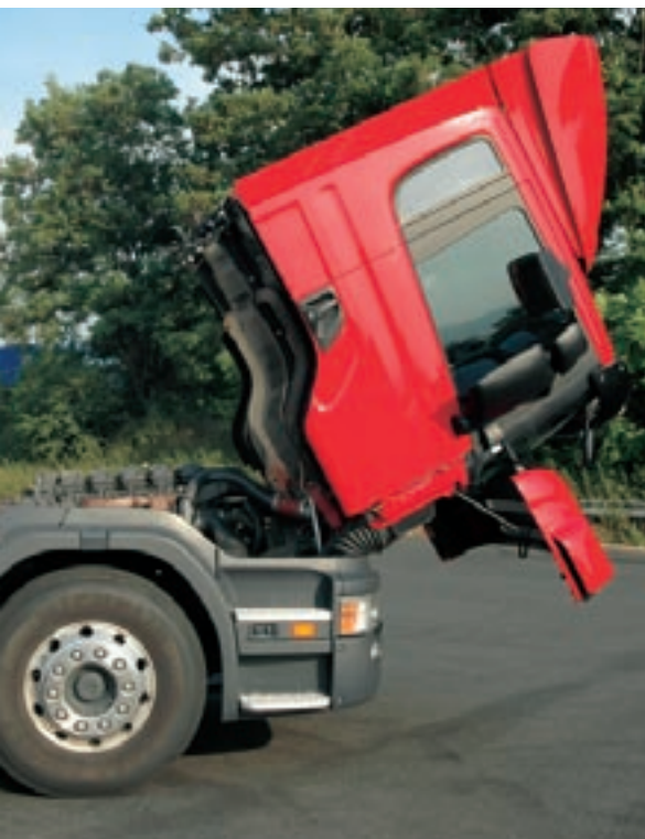
Gut zugänglich: Dank des großen Kabinen-Kippwinkels sind sowohl der Motor als auch andere Aggregate einfach erreichbar.
