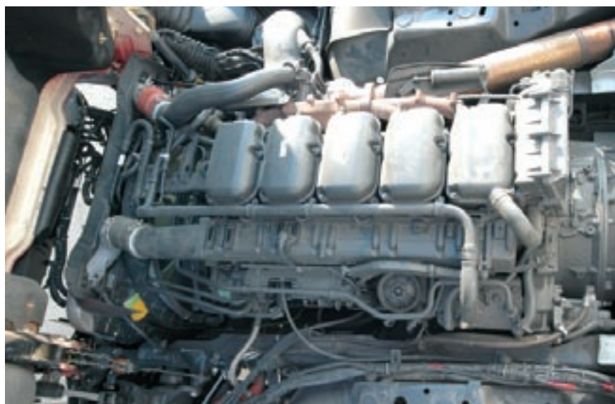
Aus der Großfamilie: Der 5-Zylinder-Diesel DC9 12 stammt aus Scantias Motorenbaukasten, der auch die 6-Zylinder- und V8-Aggregate umfasst.
