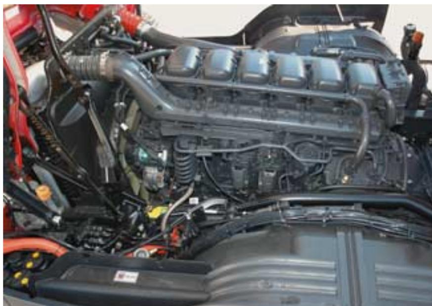
**Der 420-PS-Hightech-Motor DT 1211 Euro 4 mit Turbocompound und EGR besitzt eine standfeste Charakteristik.**
