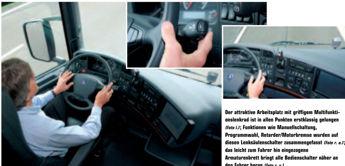
**Der attraktive Arbeitsplatz mit griffigem Multifunktionslenkrad ist in allen Punkten erstklassig gelungen (Foto 1.); Funktionen wie Manuellschaltung, Programmwahl, Retarder/Motorbremse wurden auf diesen Lenksäulenschalter zusammengefasst (Foto r. o.); das leicht zum Fahrer hin eingezogene Armaturenbrett bringt alle Bedienschalter näher an den Fahrer heran (Foto r. u.).**
