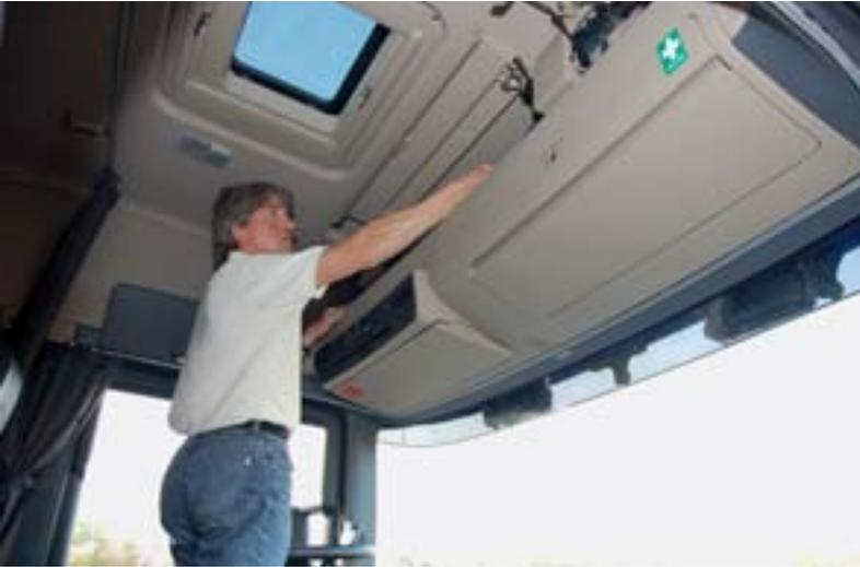
**Die Highline-Kabine ist jetzt mit verschließbaren Ablagefächern über der Windschutzscheibe ausgestattet.**
