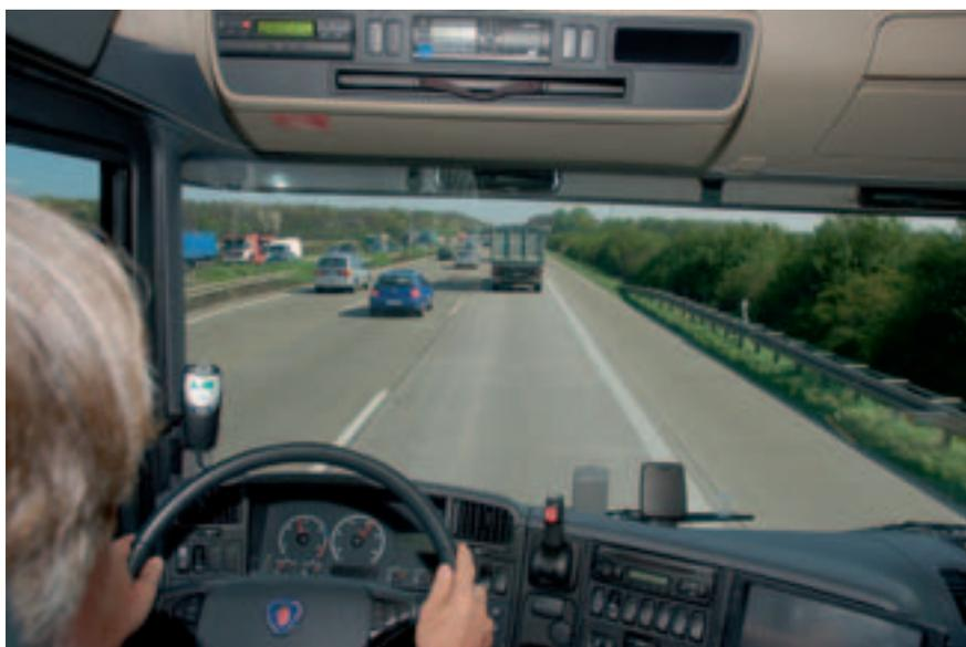
Beim R 500 sorgt der mächtige V8-Diesel für den Vortrieb. (oben) Der Fahrerplatz in der Highline-Kabine ist übersichtlich instrumentiert und ergonomisch vorbildlich gelungen. (unten)
